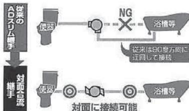
横枝管接続部の流入形状の効果で、汚水の対面横枝への飛出しを防止
