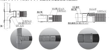
トヨドレンダブル管は内面平滑で、塩ビ管 と同等の粗度係数。
