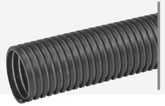
特殊なリブ構造を持つカナネットは、外面コルゲート状の山部とネット状の吸水孔を有する谷部で構成され、外圧に強く、軽量でフレキシブルに曲がる暗渠排水管です。特殊ネット状吸水孔の採用により、土砂などの目詰まりがなく、優れた吸水能力を発揮します。
